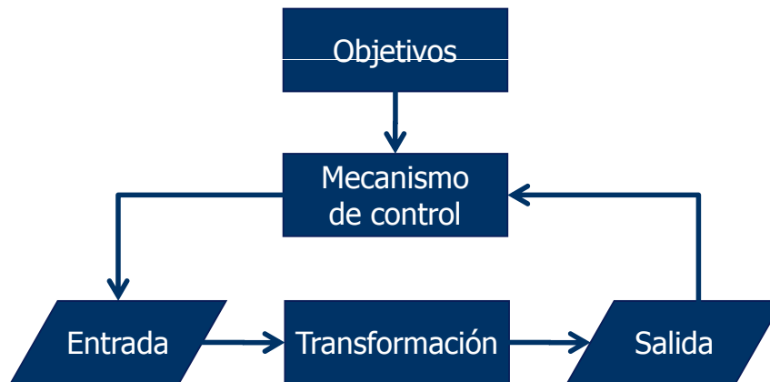
Sistema con realimentación
